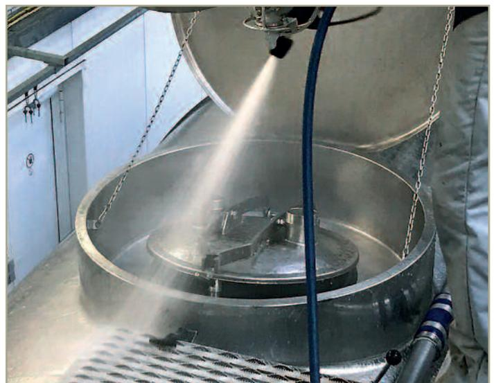
Abb. 2: Kritische Bereiche der Reinigung: Mannlöcher, Dichtungen, Rohrleitungen, Ventile, Pumpen, etc.
