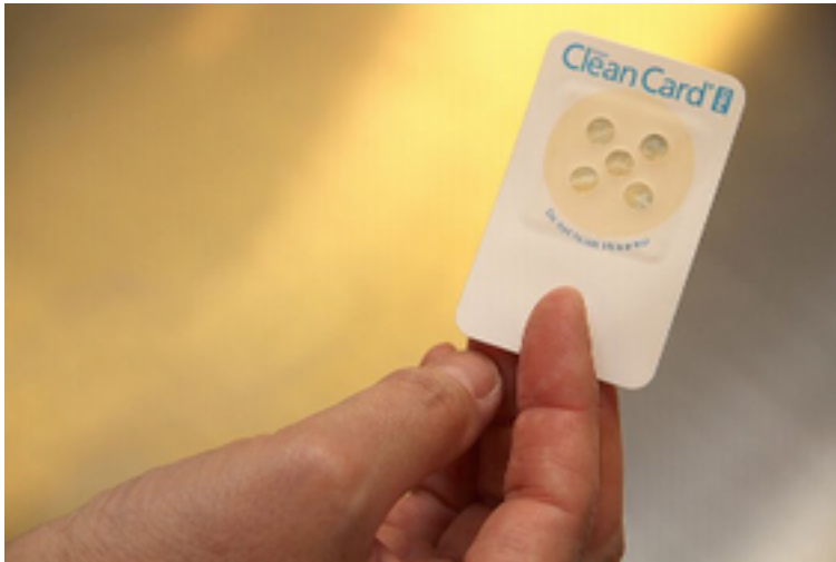
Hygiene-Schnelltest: Die „Clean Card Pro“ entdeckt Protein-Rückstände auf allen Arbeits- und Kontaktflächen in nur 30 Sekunden
